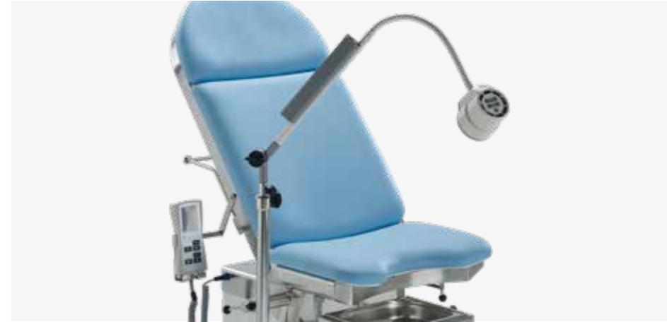
Art-Nr. 82348 Untersuchungsleuchte zur Anbringung an Halterung 82349_1, 82349_2 oder 82349_3 • LED-Technologie (50'000 lx / 0.5 m) • Lichtfeld 180 mm • Präzise Farbwiedergabe Ra >93 • Lichtfarben 3300 K, 3800 K oder 4400 K • Beleuchtungsstärke 5-stufig dimmbar • Bedieneinheit am Leuchtenkopf • Stufenloses Positionieren durch flexiblen Arm • Geringe Wärmestrahlung im Licht
