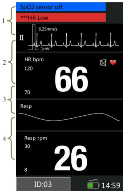
Fig 1-7 EKG-Anzeigemodus mit Atmung
