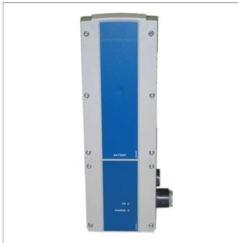
Die Ladestation wird mit zwei Schrauben an eine Wand montiert. Wichtig ist eine senkrechte Orientierung der Station, so dass die Kontakte des Akkus durch die Schwerkraft sicher auf die Lade pole gedrückt werden.
